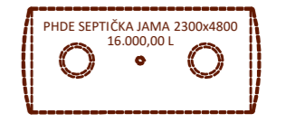
Подземна водонепропусна септичка јамa
