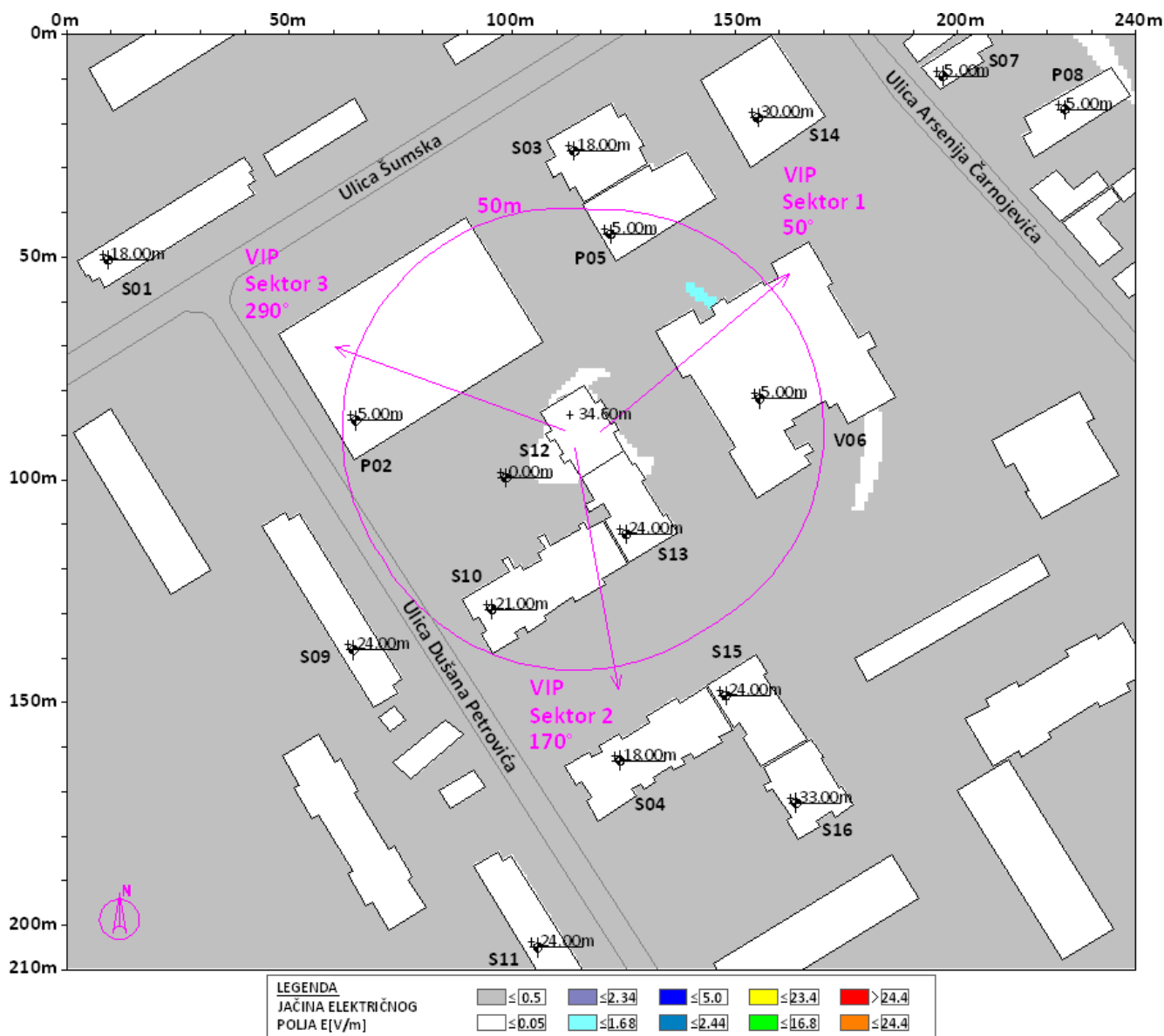
Slika 6.16 Rezultati proračuna jačine električnog polja u široj okolini lokacije bazne stanice na visini +1.70m (prosečna visina čoveka) u odnosu na nivo tla za slučaj rada sistema DCS1800 operatera VIP . Maksimalna proračunata vrednost jačine električnog polja iznosi E=0.54 V/m
