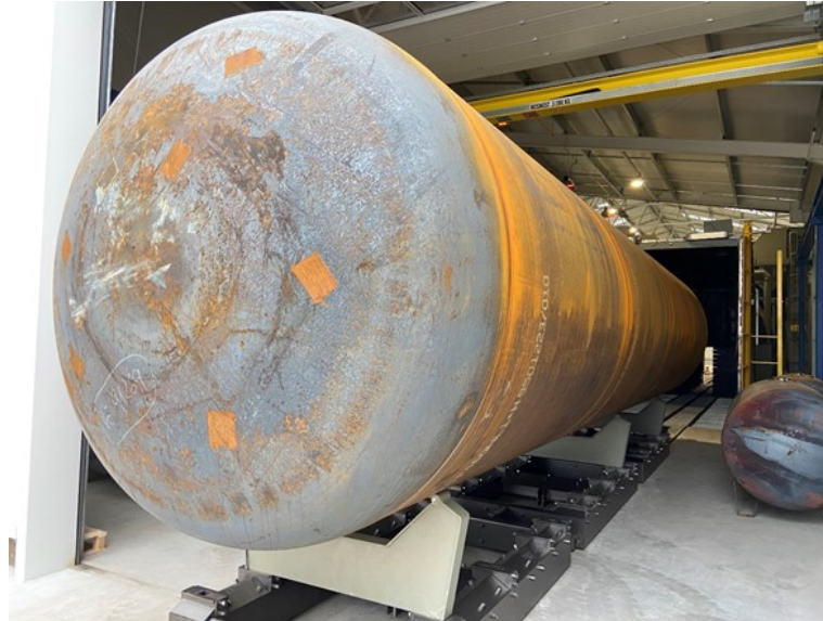
Slika 26. Ulaz vagona u sačmaru
