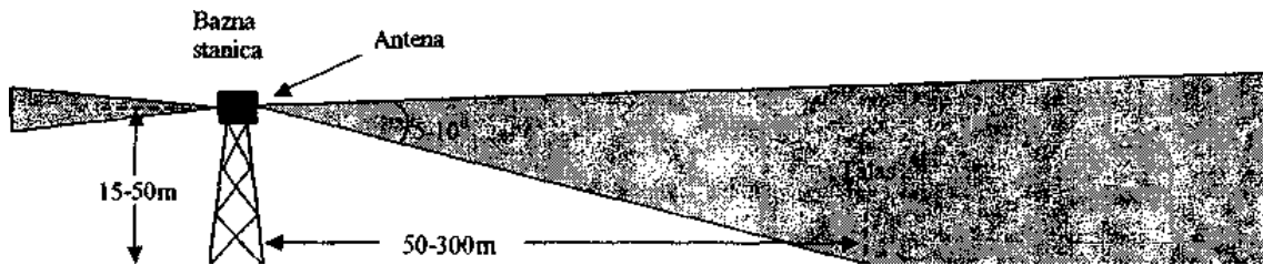
Slika 6.2A Izgled glavnog snopa zračenja antene u makroćeliji, zbog postojanja nagiba
